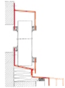
Wandverglasung vorgehängte Fassade (VF) 40 mm Paneele
